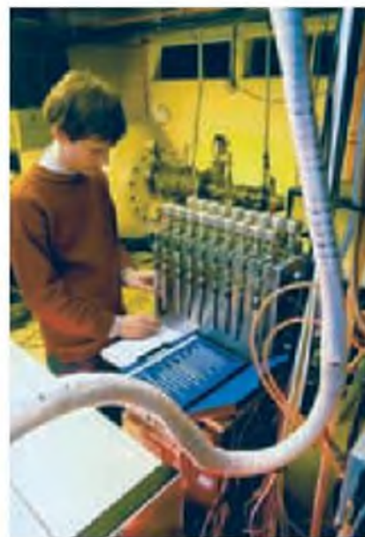
▲ Figura 21.9 Fechado por radiocarbono. Esta máquina, un acelerador lineal, analiza la cantidad de carbono-14 en el dióxido de carbono producido por la combustión de una muestra en oxígeno. La relación de carbono-14 a carbono-12 está relacionada con el tiempo desde la muerte del animal o la planta que se está investigando.
